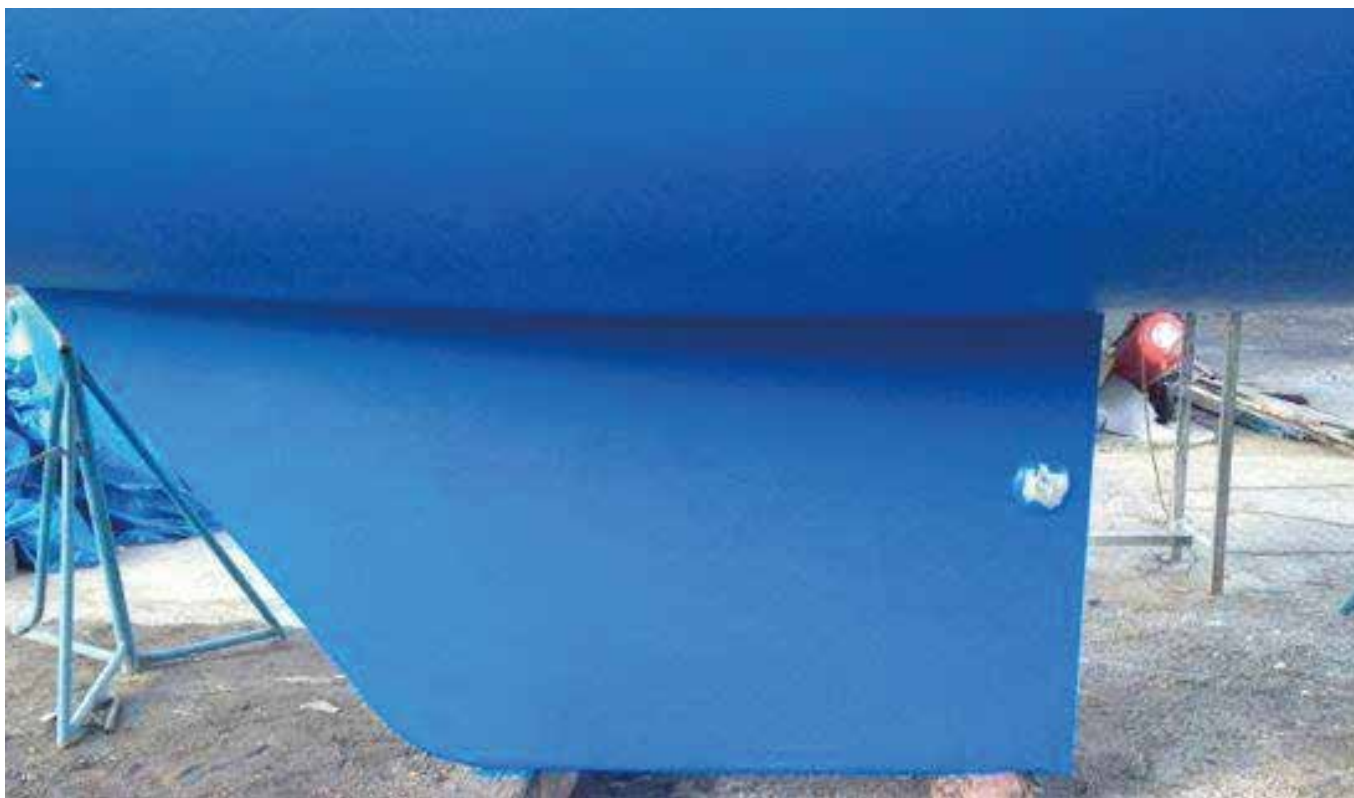
Antifouling autopolissant (3couches)
